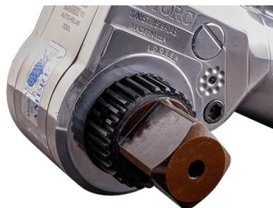
La ICE puede liberarse automáticamente cuando se encuentra bloqueada en un perno. Esto reduce las interrupciones no planificadas en el proceso de empernado.
