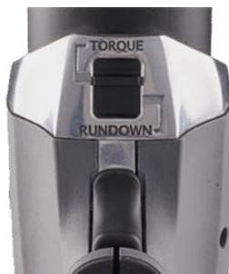
Con un simple interruptor, la SERIE LITHIUM pasa de modo de ajuste en alta velocidad a modo de precisión de torque final, eliminando la necesidad de múltiples sistemas en un trabajo. La caja de engrane mecánica de alta precisión provee una potencia constante sin las vibraciones y ruidos que se encuentran en las pistolas de impacto. Ajuste la potencia usando el visor digital en la parte trasera de la pistola para seleccionar el torque deseado para cada trabajo.
